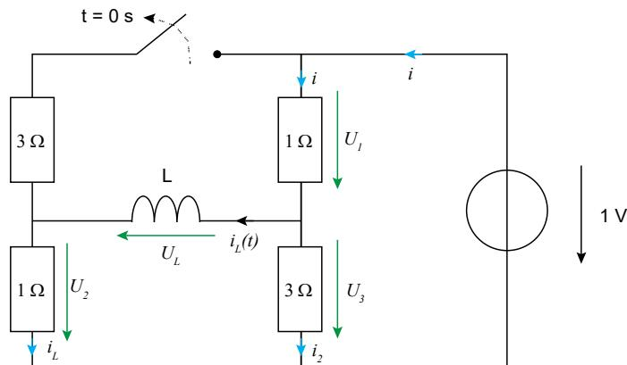
1) Montrez que la valeur du courant traversant la bobine à l'instant  $t = 0 \text{ s}$  est de  $1/3 \text{ A}$ .
