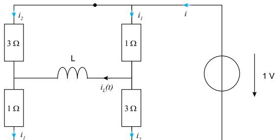
On remarque la symétrie du circuit. La bobine n'a pas de tension en régime continu, les résistances de 1 et  $3 \Omega$  sont donc en parallèle. Le courant total est donc :  $i = \frac{1}{2(3//1)} = \frac{2}{3} \text{ A}$
